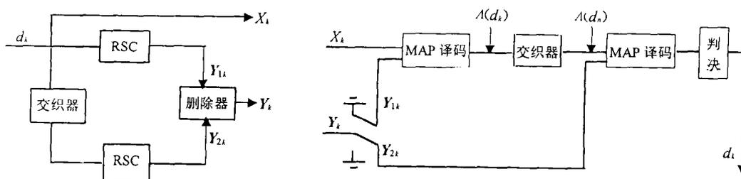
图 1 Turbo 码编码、译码原理图
