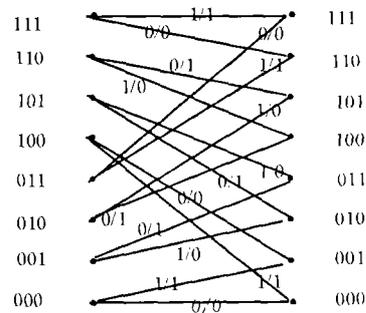
图 4 (15, 13)RSC 码状态转移网格图
