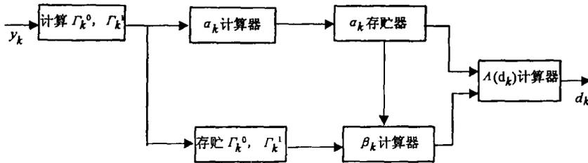
图 2 Turbo 码译码的矩阵算法流程图
