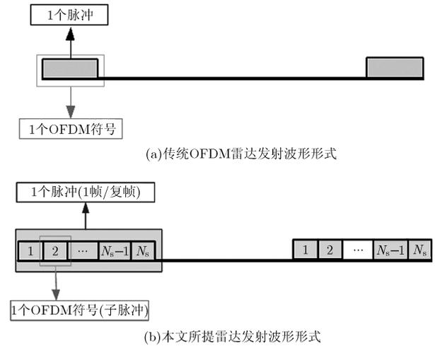
图1 OFDM雷达发射波形形式
