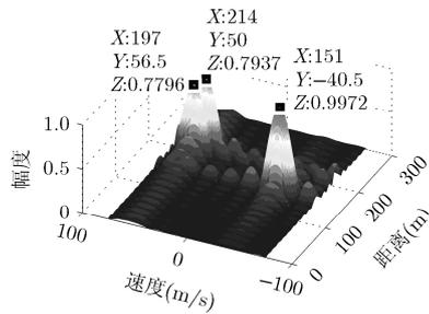
图5 FFT 算法距离速度联合估计
